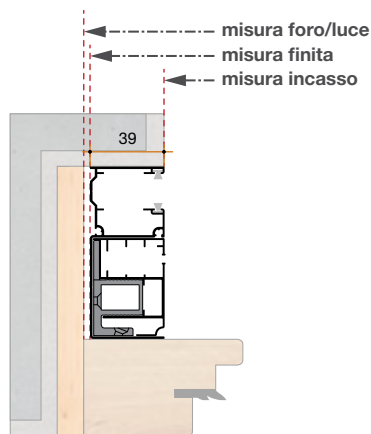
Esempio di installazione Guida Tapparella da 90 mm
