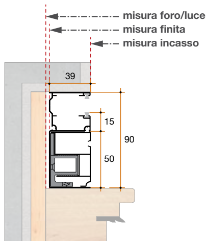
Esempio di installazione Guida Tapparella da 90 mm
