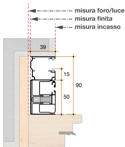
Esempio di installazione Guida Tapparella da 90 mm
