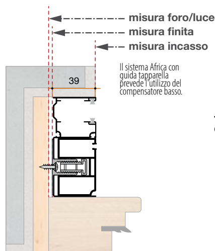
Esempio di installazione Guida Tapparella da 90 mm
