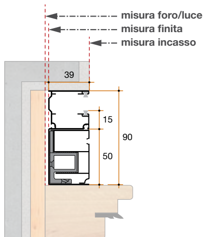
Esempio di installazione Guida Tapparella da 90 mm
