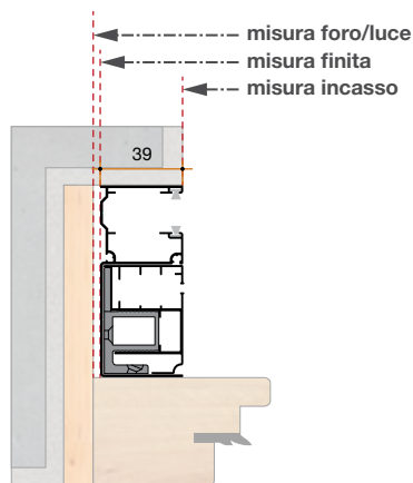
Esempio di installazione Guida Tapparella da 90 mm
