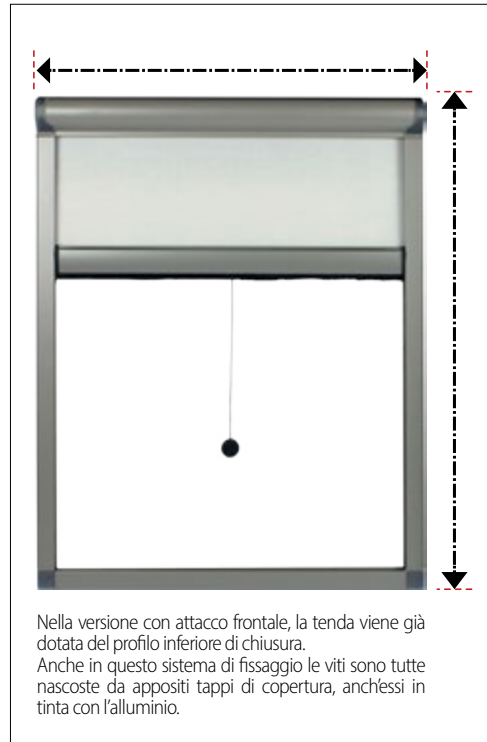
Attacco frontale - misure finite
