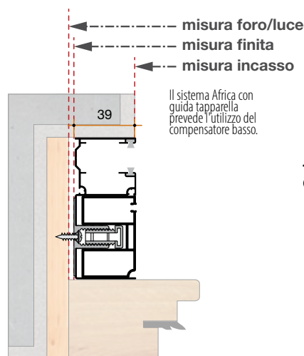
Esempio di installazione Guida Tapparella da 90 mm
