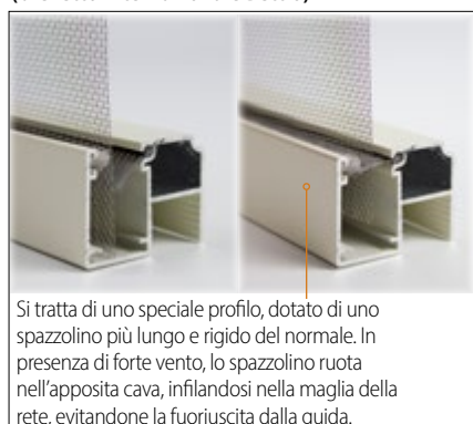
Guida con sistema antivento (brevetto internazionale Bettio)
