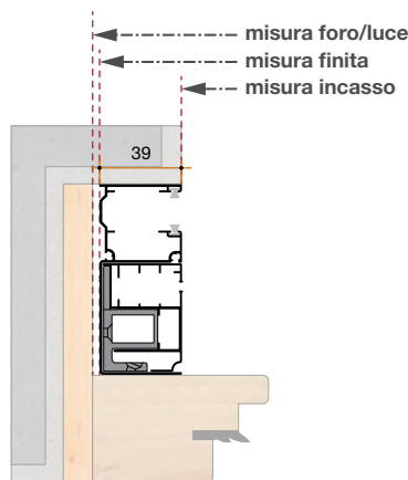
Esempio di installazione Guida Tapparella da 90 mm
