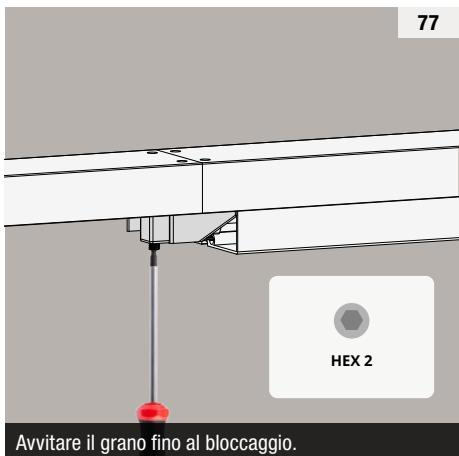
Avvitare finché la guida sia parallela al compensatore.
