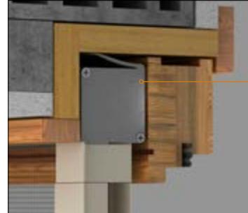
In caso di applicazione in cantiere questo inserto facilita l'installazione tenendo ferma la zanzariera all'interno dell'imbotte predisposta.
