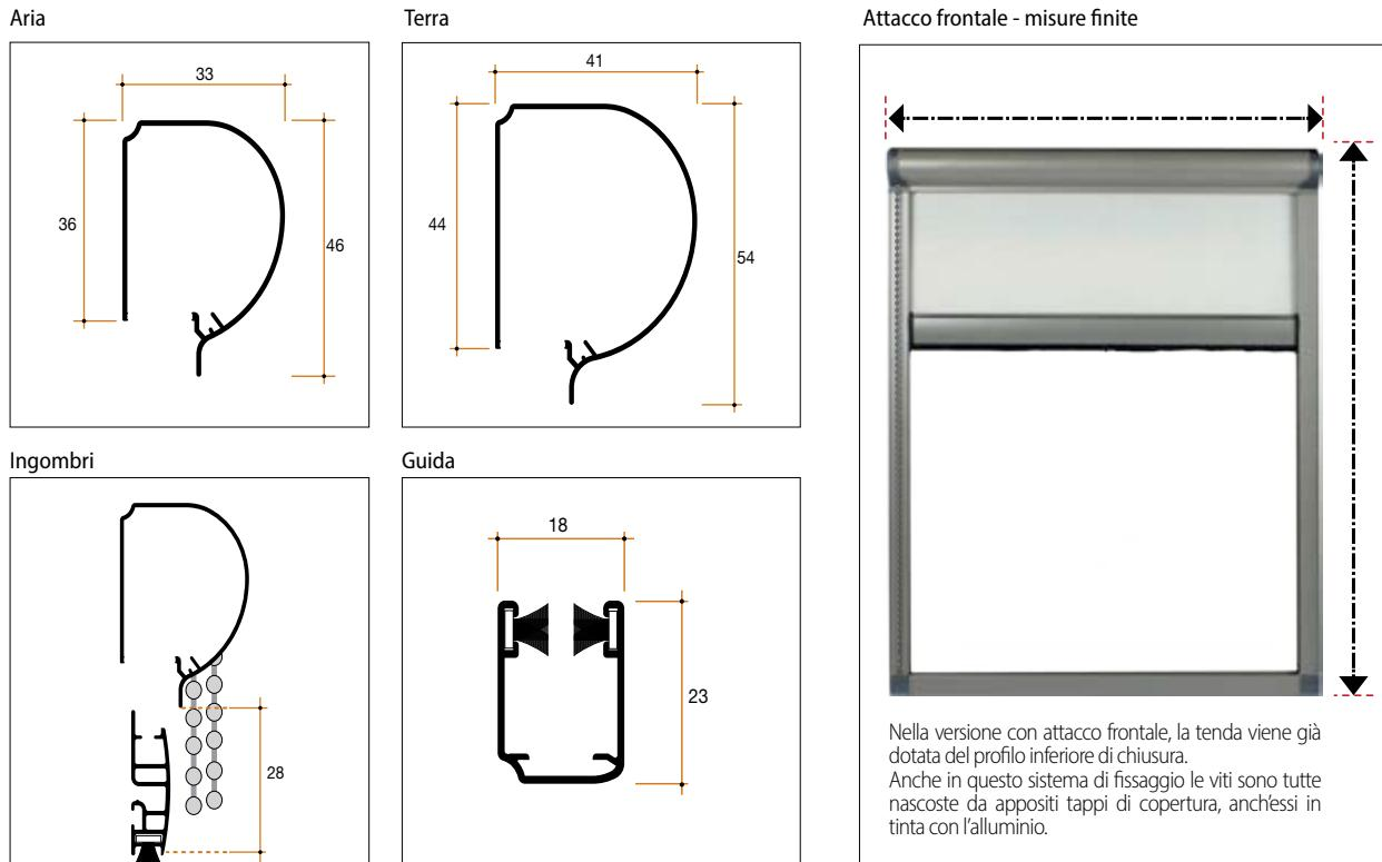
Nella versione con attacco frontale, la tenda viene già dotata del profilo inferiore di chiusura. Anche in questo sistema di fissaggio le viti sono tutte nascoste da appositi tappi di copertura, anch'essi in tinta con l'alluminio.
