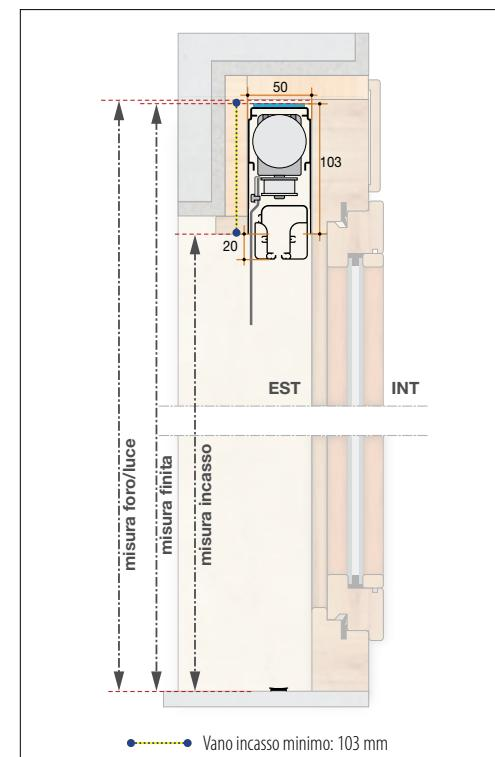
**Sezione orizzontale 1 battente con incasso 3 lati e Copri Cassa Facile (di serie)**
