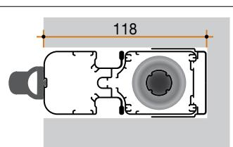
ATTENZIONE: per la corretta installazione di Neoscenica® V2 (versione studiata per il montaggio in presenza di cielino non portante) a due battenti, è necessario considerare l'altezza della staffa incasso (rappresentata in azzurro) per il fissaggio frontale sul serramento.
