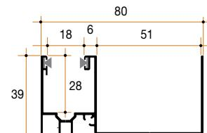
Esempio di installazione Guida Tapparella da 90 mm
