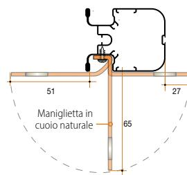
Maniglietta flessibile in cuoio naturale, realizzata a mano, che permette di estrarre la barra maniglia quando l'impugnatura di essa non è accessibile perché coperta dal serramento o da altro impedimento. Grazie a questo accessorio si può prevedere l'incasso totale della barra maniglia.
