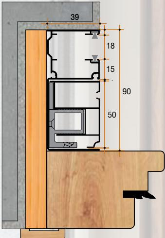
Esempio guida tapparella da 90 mm con guida e compensatore modello Delta
