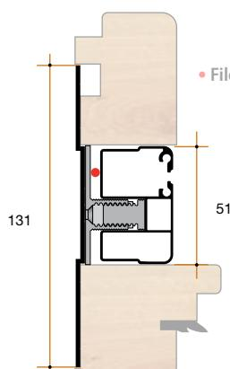
Esempio con guida e compensatore basso
