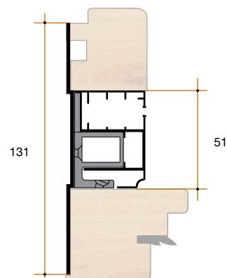
Esempio con guida e compensatore
