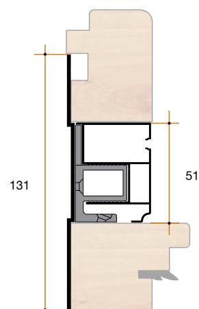
Esempio con guida e compensatore
