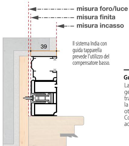
Esempio di installazione Guida Tapparella da 90 mm
