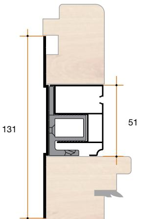
Esempio con guida e compensatore modello Delta
