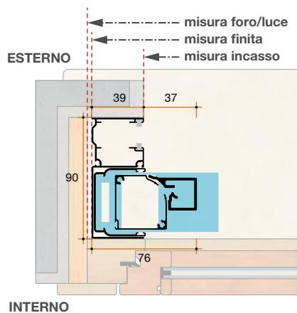
Esempio di installazione Guida Tapparella da 90 mm
