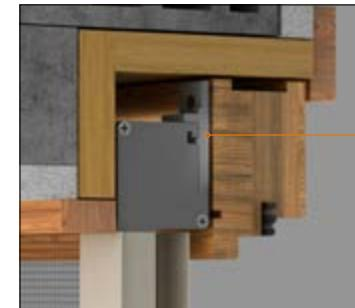
Se invece si preferisce il montaggio in officina questo utile accessorio permette di ancorare il cassetto della zanzariera direttamente al serramento.
