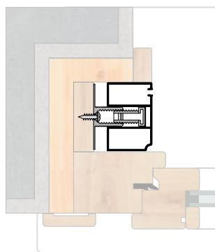
Nel caso in cui non si disponga di 50 mm di incasso, allora è possibile richiedere questo compensatore più basso. Grazie alla sua funzione telescopica, permette anche di compensare da 34 a 48 mm e mediante il suo blocco di sicurezza, non consente all'utilizzatore finale di modificare accidentalmente la vostra regolazione. Questo piccolo dettaglio vi permette di assicurare un'installazione a regola d'arte.
