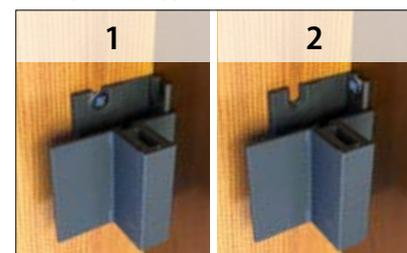
Appositamente predisposti, i compensatori consentono di fissare la guida sul fondo del contro telaio per le installazioni in "cantiere" (tipologia 1) oppure di fissare la guida al serramento (tipologia 2) prima di recarsi in "cantiere", trasportando serramento e zanzariera già pre-montati.
