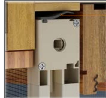
In caso di applicazione in cantiere questo inserto facilita l'installazione tenendo ferma la zanzariera all'interno dell'imbotte predisposta.
