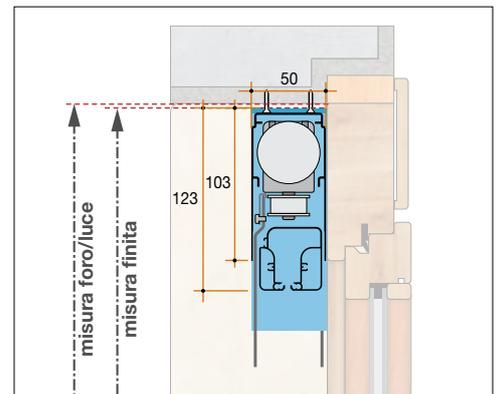
**Sezione orizzontale 2 battenti con staffa attacco superiore**
