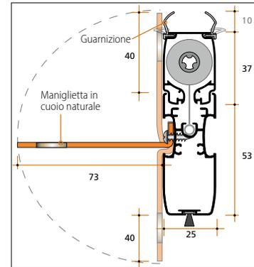
**Compensatore e guida antiventò montata.**
