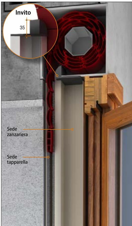
Al fine di integrare con facilità il sistema zanzariera con il sistema tapparella sono state create due guide specifiche dotate di una sezione, completa di spazzolini e di apposito invito per lo scorrimento della tapparella (profilo 14x55 mm) e una seconda sezione per l'inserimento dei sistemi zanzariera incasso da 50 mm. Un sistema integrato che arricchisce la casa con una finitura sicuramente di alto pregio.
