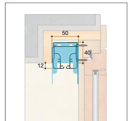
ATTENZIONE: per la corretta installazione di **Neoscenica® V2** (versione studiata per il montaggio in presenza di cielino non portante) **a due battenti**, è necessario considerare l'altezza della staffa incasso (rappresentata in azzurro) per il fissaggio frontale sul serramento.
