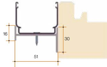
Il compensatore in alluminio risolve brillantemente la problematica di installazione in presenza di avvolgibili in monoblocco con cielino ispezionabile dall'esterno, in quanto consente di ancorare la parte superiore della zanzariera direttamente sul serramento.
