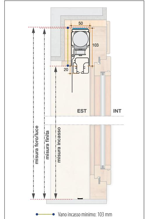
**Sezione orizzontale 2 battenti con staffa attacco superiore con incasso 3 lati**
