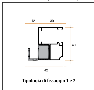
Guida antivento e compensatore in nylon
