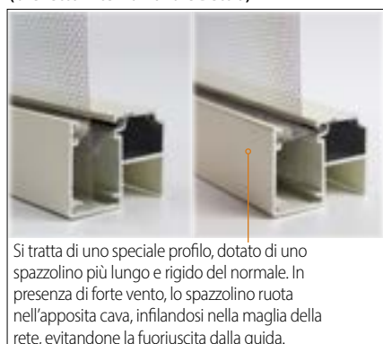
Guida con sistema antivento (brevetto internazionale Bettio)
