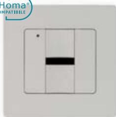
Comando a parete da 1 canale. Si può comandare un singolo motore oppure un gruppo di motori associati allo stesso comando. Completo di cornice e supporto a muro. Apertura, stop, chiusura. Per uso interno. Dim. 80 x 80 x 10 mm. Tipologia batteria: 3V CR2032. Classe di sicurezza: classe III. Portata: 15 m attraverso 2 muri portanti. Colore bianco.
