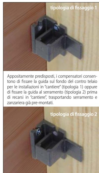
Appositamente predisposti, i compensatori consentono di fissare la guida sul fondo del contro telaio per le installazioni in "cantier" (tipologia 1) oppure di fissare la guida al serramento (tipologia 2) prima di recarsi in "cantier", trasportando serramento e zanzariera già pre-montati.
