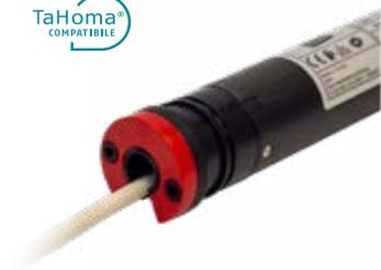
Motore 230 V AC con ricevitore incorporato. Regolazione dei finecorsa elettronici direttamente dal telecomando. Operatore a doppio isolamento che non richiede la connessione del filo di terra. Semplicità di installazione e cablaggio ridotto al minimo. Compatibilità con tutta la gamma di telecomandi e sensori RTS. Compatibilità con TaHoma. Grado di protezione: IP44
