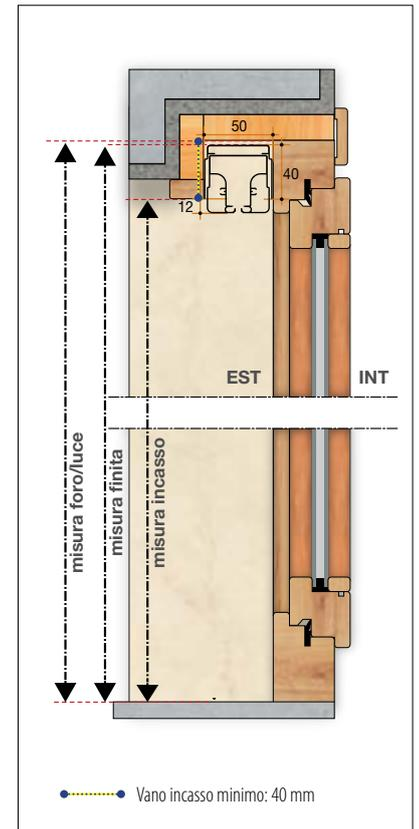
2 Dettaglio V2 – Sezione verticale a due batt
