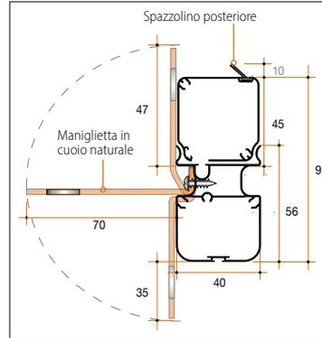
**Compensatore e guida montata.**
