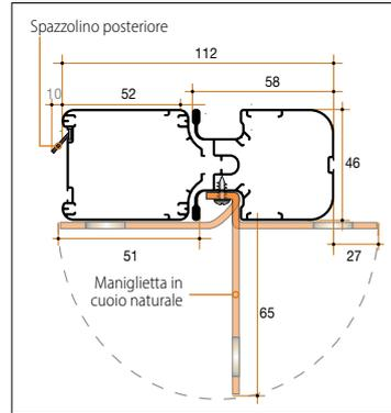
**Compensatore e guida montata.**
