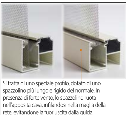
Guida con sistema antivento (brevetto internazionale Bettio)
