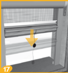
Inserire i PARASIGOLI alle estremità della barra maniglia
