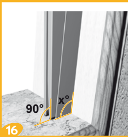
Con la chiave esagonale agire sui regolatori per ottimizzare la posizione delle guide
