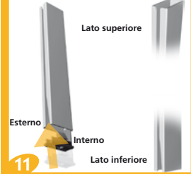
Con la chiave esagonale agire sui regolatori per ottimizzare la posizione delle guide
