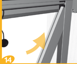
Inserire i PARASIGOLI alle estremità della barra maniglia
