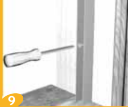
Ruotare i regolatori di 90 gradi
