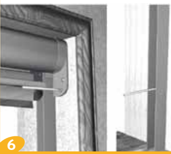
Segnare la posizione dei fori per le cuffie e per le guide
